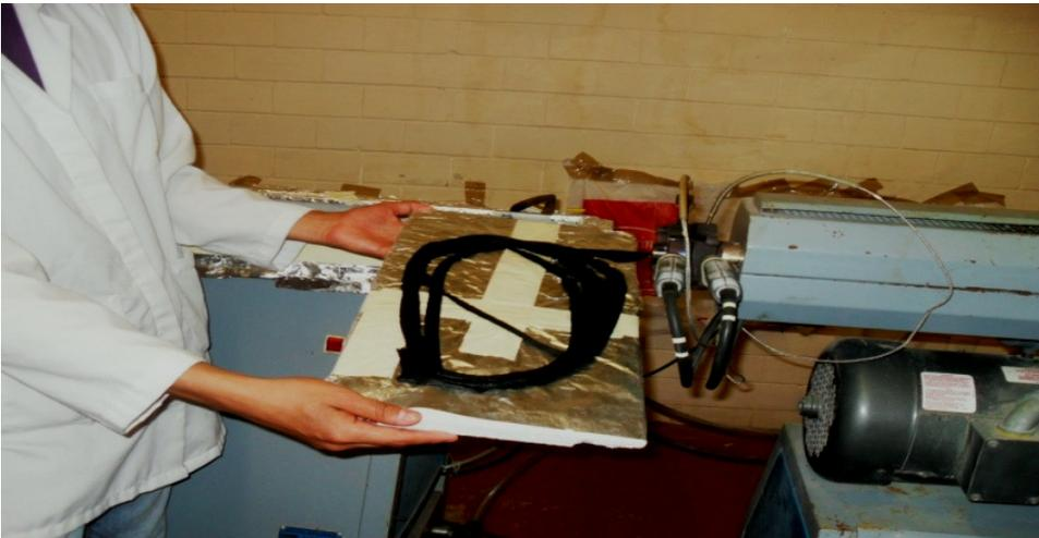
Fibra de carbono obtenida por medio de extrusión en el laboratorio del ITCM.
